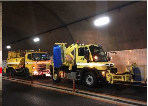
《トンネル側壁清掃》
