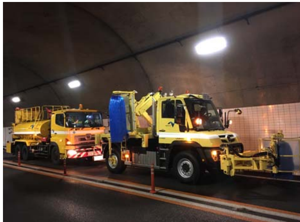
《トンネル側壁清掃》
